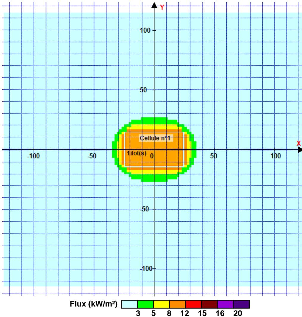
Pour information : Dans l'environnement proche de la flamme, le transfert convectif de chaleur ne peut être négligé. Il est donc préconisé pour de faibles distances d'effets comprises entre 1 et 5 m de retenir une distance d'effets de 5 m et pour celles comprises entre 6 m et 10 m de retenir 10 m.
